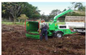
Prije kompostiranja granje se strojno usitnjava – sječka
