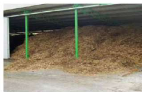
Usitnjeni materijal odlaže se u prozračne prostore radi prirodnog procesa sušenja
